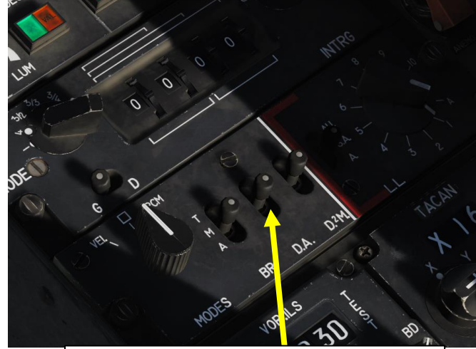
DA ( Détecteur d'Alerte ) Power Switch • T = Test • M = MARCHÉ = ON • A = ARRÊT = OFF
