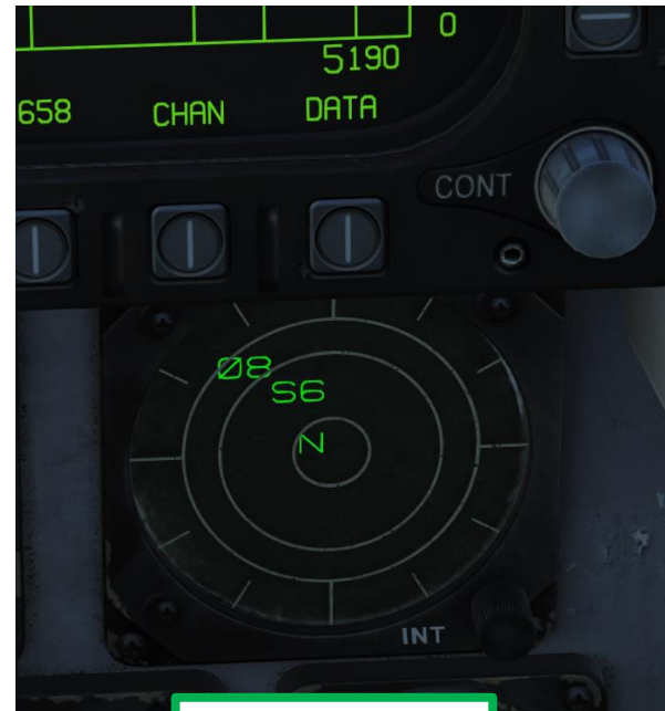
RWR Azimuth Display
