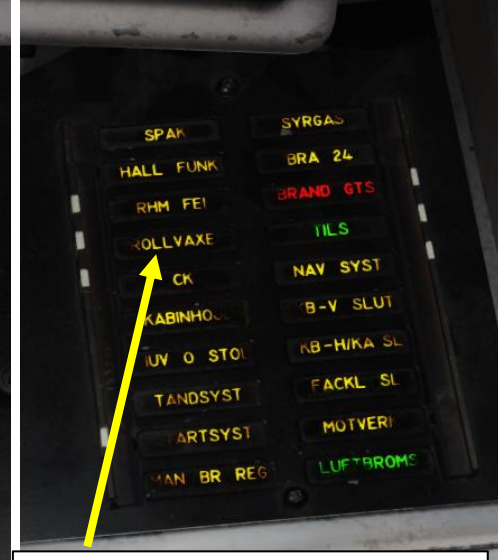
ROLL VÄXEL: Roll Gearing system failure
